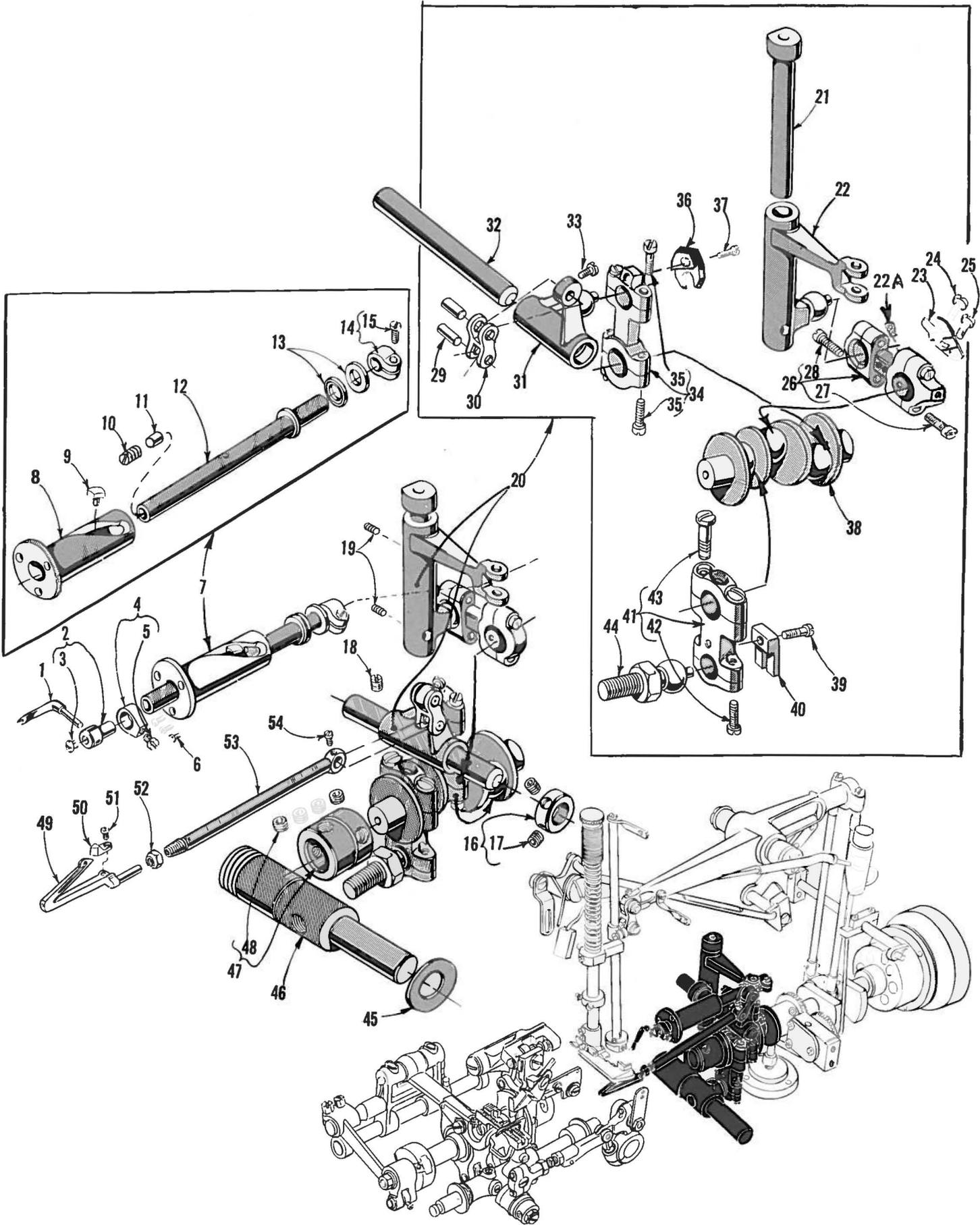
LOOPER (503) STITCH) AND SPREADER DRIVE MECHANISM
